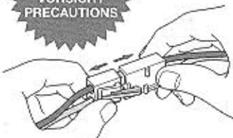
走行させない時は必ず走行用バッテリーのコネクターをはずしてください。走行用バッテリーをつないだままおくと、車が暴走することがあります。走らせないときは、必ず走行用バッテリーのコネクターを抜いておきます。
